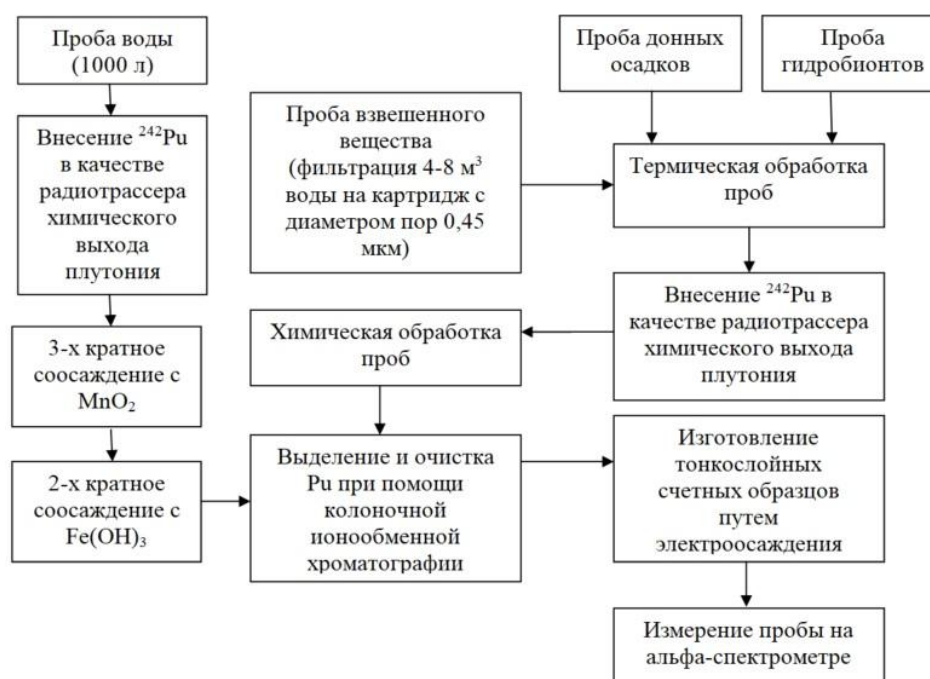
Рисунок 2.2 – Обобщенная схема многоступенчатой методики определения альфа-излучающих радиоизотопов плутония в природных объектах
